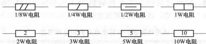
图 1-3 电阻器额定功率的符号表示
