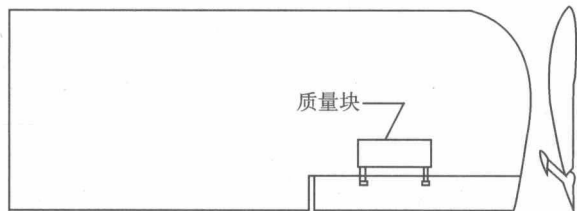
图 1.2 解决副翼颤振问题的质量平衡法
