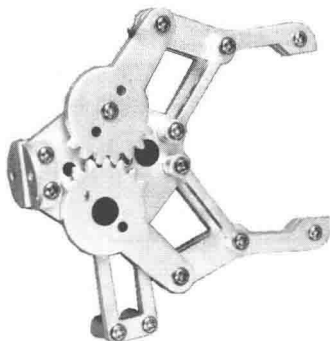
(a) 齿轮与四杆机构结合的机械手
