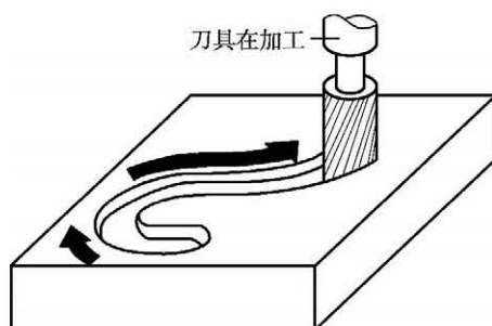
图 1-13 轮廓控制加工示意图
