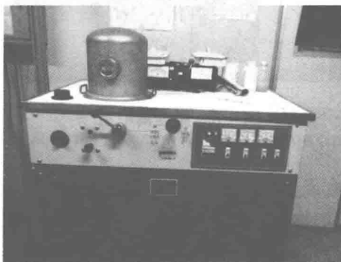
图 1.7 金属电极制备镀膜机
