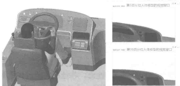
图 3 改良后的 BRT 司机可视区域(团队协作)
