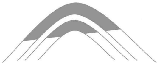
图 1.2.2 油藏剖面图(I)
