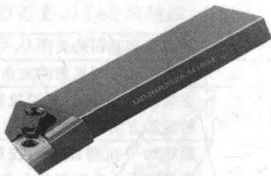
图 1-20 机夹可转位车刀
