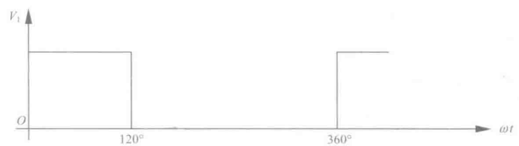
图 1.5 转子位置传感器输出波形图
