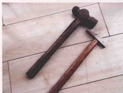
图1-18 铁锤 检查房屋墙体与地面是否空鼓及其他房屋内部构造
