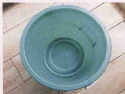
图1-19 水桶 验收下水管道、地漏是否阻塞，也可以做闭水试验
