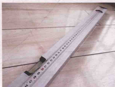
图1-17 水平尺 测量墙面、地面、门窗及各种构造的平整度
