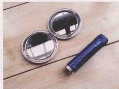
图1-21 小镜子和手电筒 用于查看隐蔽的构造或细节及其他照明采光不足的部位
