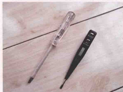
图1-20 试电笔 测试各插座是否畅通
