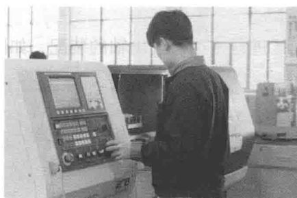
图1-9 程序输入及零件加工
