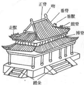
图3 歇山顶基本构造
