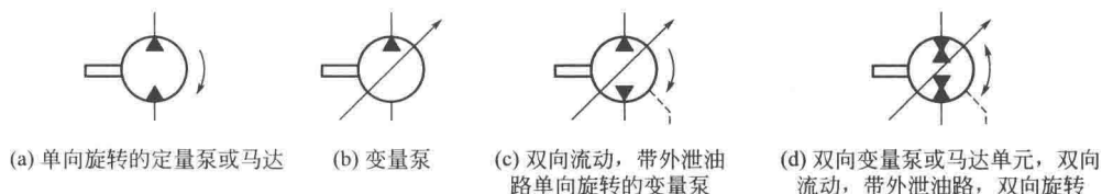
图2-4 液压泵的图形符号(2009新标准)
