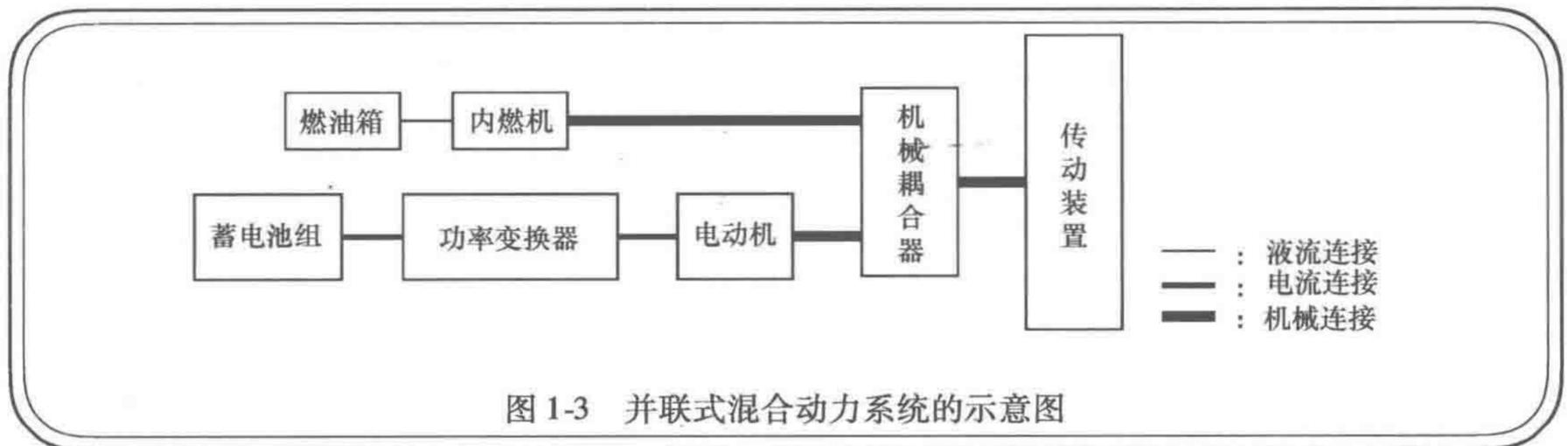
图 1-3 并联式混合动力系统的示意图
