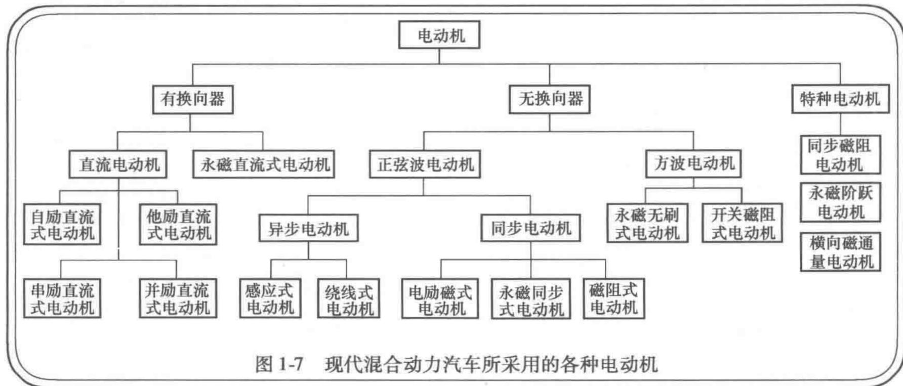
图 1-7 现代混合动力汽车所采用的各种电动机
