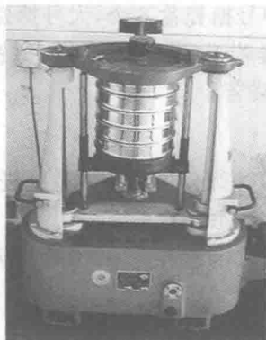
图 2-1 SPB200 拍击式振筛机
