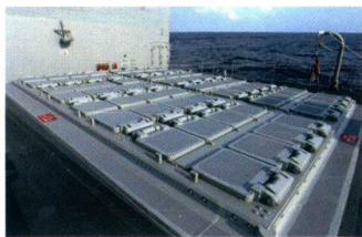
美国“提康德罗加”级巡洋舰配备的 Mk 41 导弹垂直发射系统
