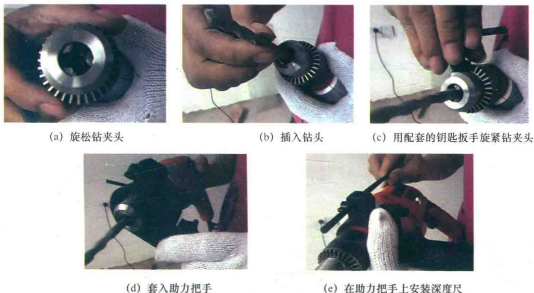
图 1-12 钻头、助力把手和深度尺的安装
