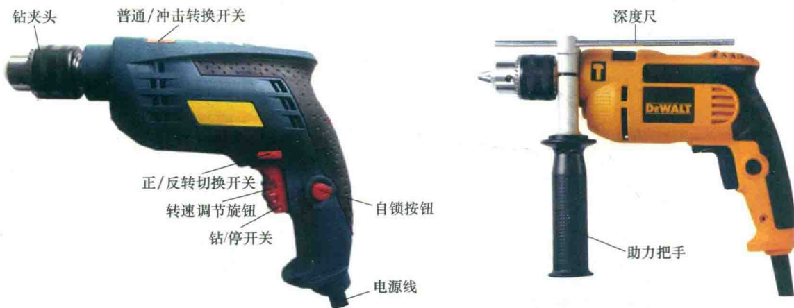
图 1-11 冲击电钻的各部分名称
