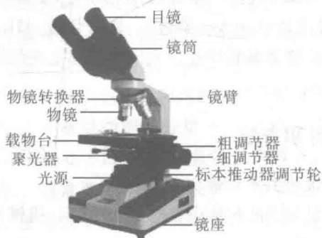
图1 普通正置显微镜结构图
