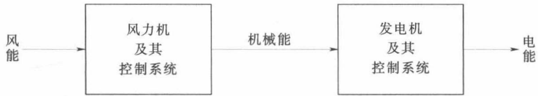
图 1-2 风力发电的能量转换过程
