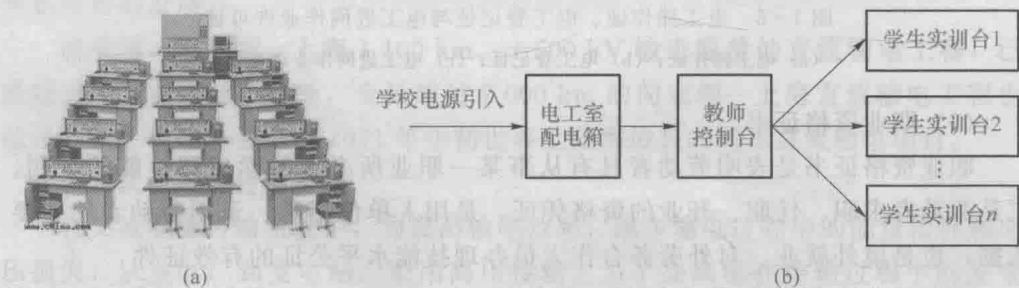
图1-7 实训室布置图和供电系统框图
