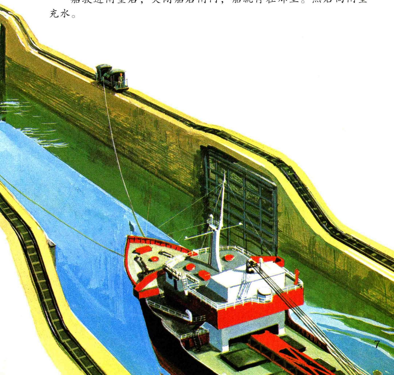
闸室充满了水后，开启船前闸门，让船浮出闸室。水位上升，船越浮越高，到达了运河较高处，或者进入另一个闸室，闸室就把船托到更高的地方去。
