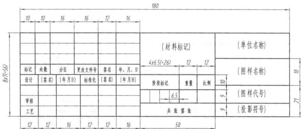
图 1-4 国标规定的标题栏格式和尺寸
