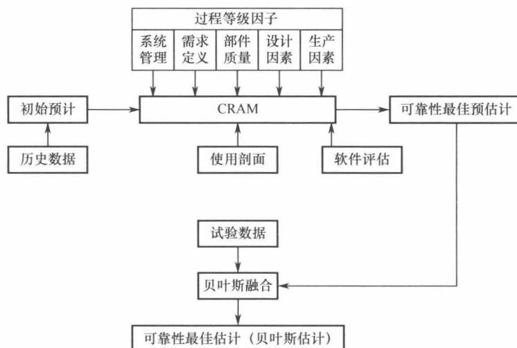
图 1-1 系统可靠性评定的 CRAM 流程
