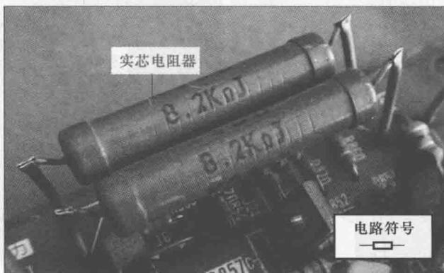
图 1-2 实芯电阻器的实物外形
