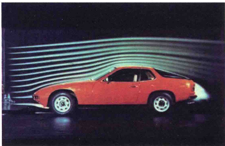
图1-9 样机模型用于风洞试验
