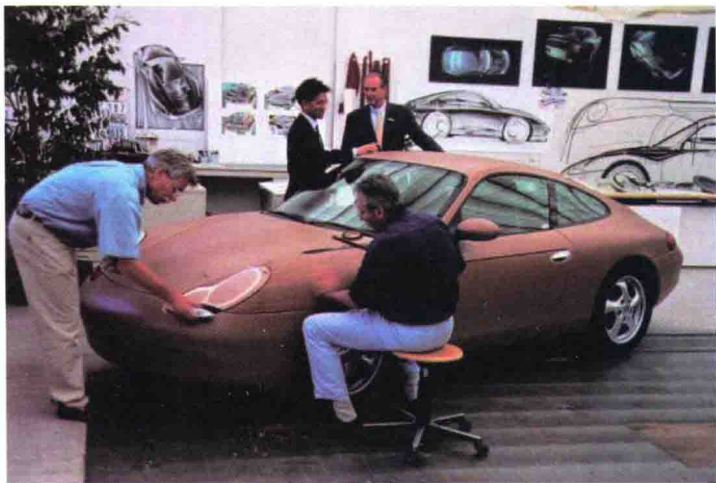
图1-11 设计师正通过油泥模型进行设计沟通
