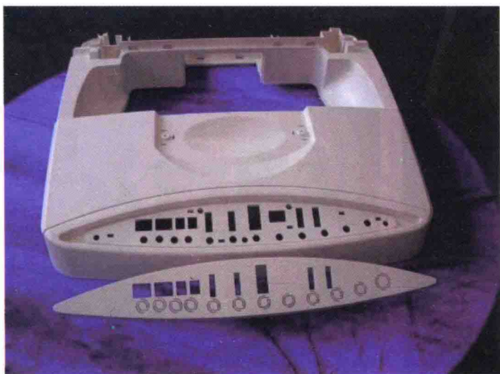
图1-8 结构样机有助于解决产品的装配问题
