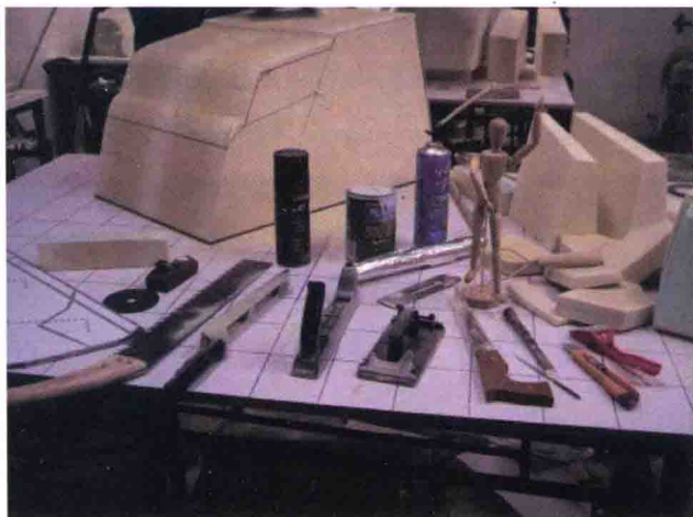
图1-4 发泡塑料及其加工工具
