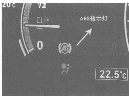
图 1-4 ABS 故障指示灯点亮
