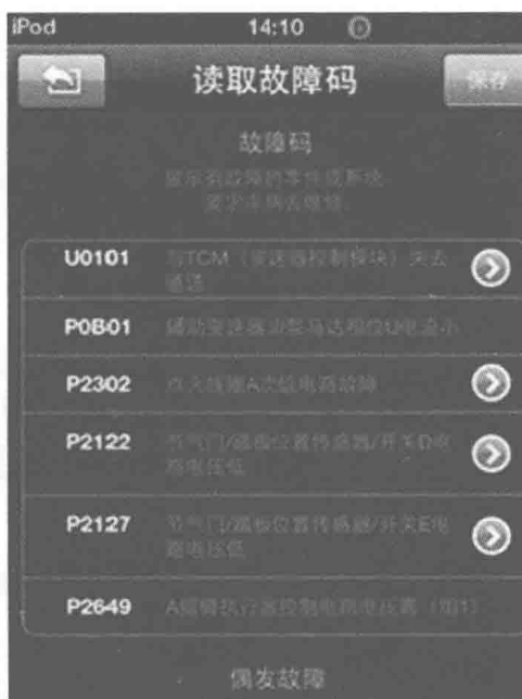
图 1-3 “车讯通”汽车诊断仪显示的故障码
