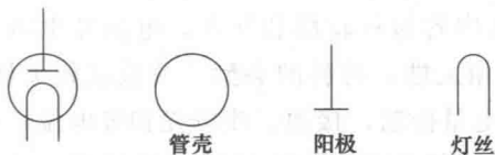
图 1-1 直热式阴极电子管的图形符号及符号要素
