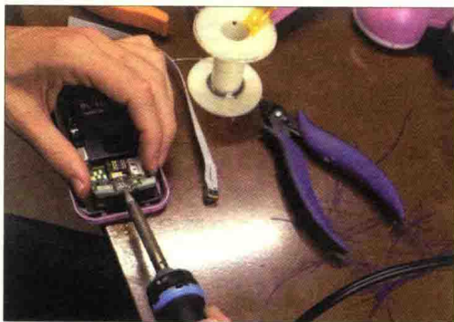
■ 图 1.8 把拍摄模块装入 LOMO 相机外壳内
