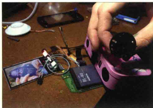
■ 图 1.6 电路试验成功，摄像头拍摄到的画面能显示在 Nokia 触控屏上
