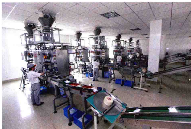
图版 47-009-3 21 世纪初现代化全自动小包装碘盐生产流水线(浙江省盐务管理局档案室提供)
