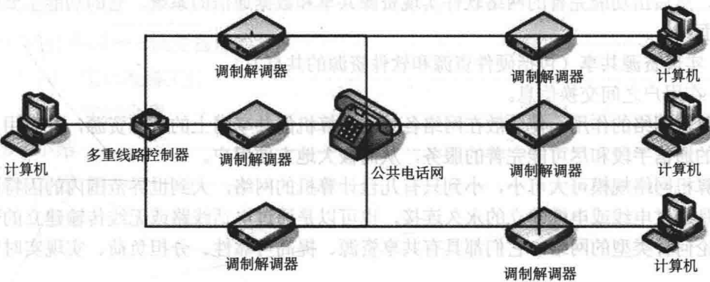
图 1-2 第一代的计算机网络模型
