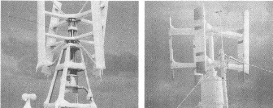
图 1-6 垂直轴风力机叶片结冰举例
