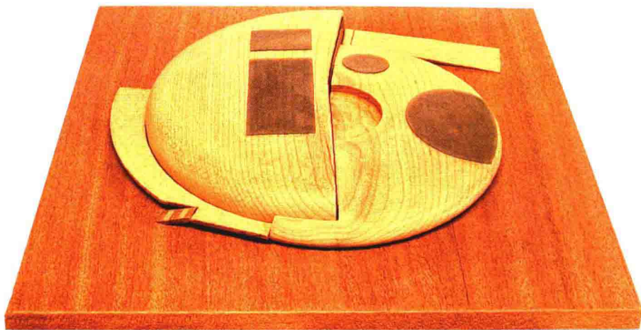
在阿布扎比的体育馆，由建筑师若阿金·普霍尔设计建造。木质的建筑模型由迈可维巴恩斯在2004年制作（比例为1:500）。展示模型通过两个方向的角度展示其体块形式。
