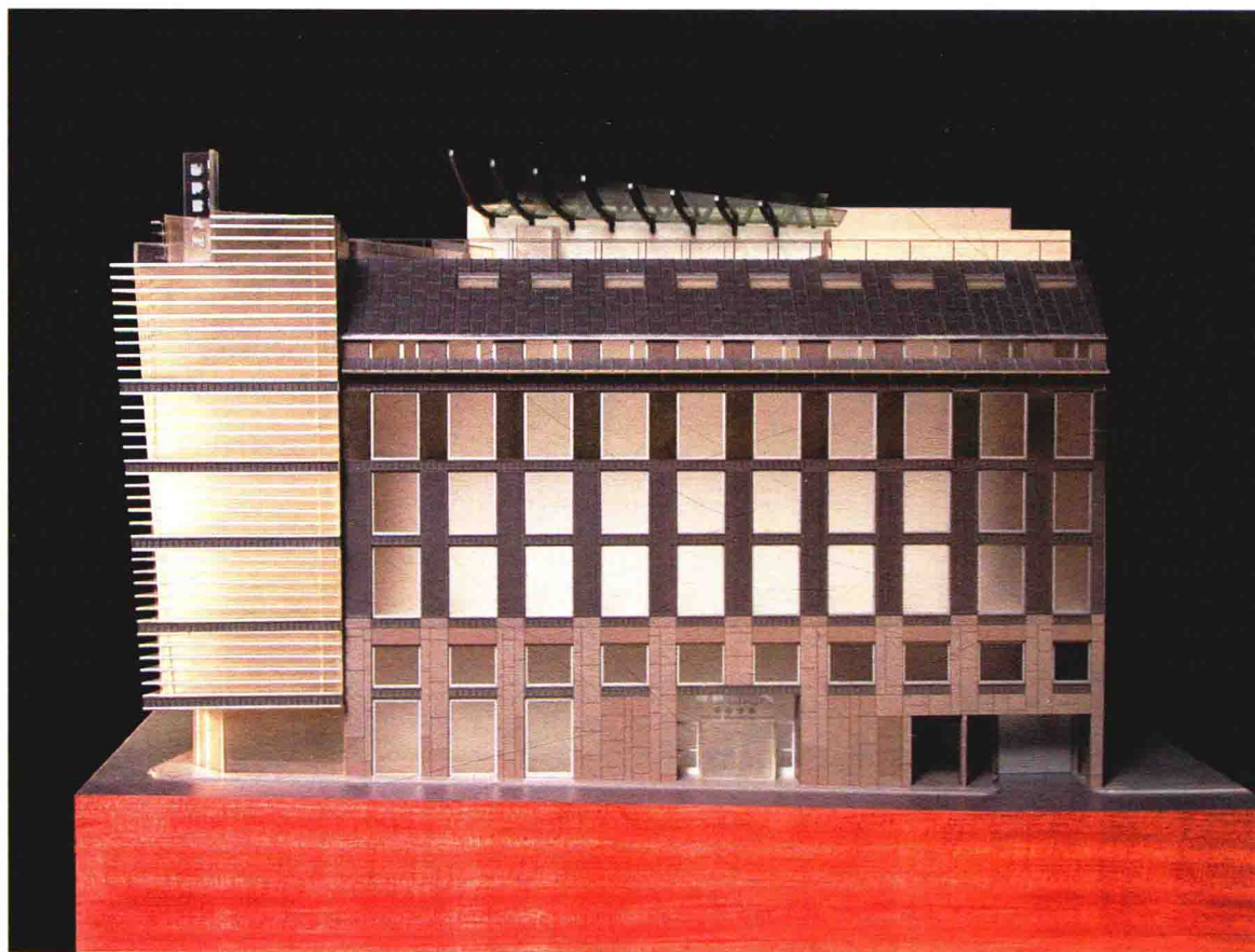
巴塞罗那的塔皮埃斯基金会，由路易斯·多梅内克和罗斯·阿曼达设计建造。由木材和丙烯酸制成的建筑模型，是由迈科维巴恩斯制作（比例为1:100）。展示出来的建筑模型的内部空间是由剖面形式展现出来的。先前存在的建筑以及家具和座位分布的位置和类型在这里展示出来，
