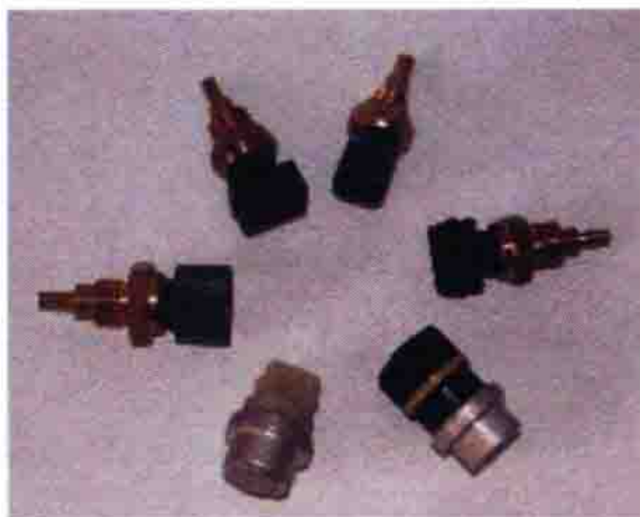
图1-4 热敏电阻器类型
