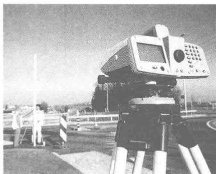
图 2-4 徕卡 DNA 系列中文数字水准仪
