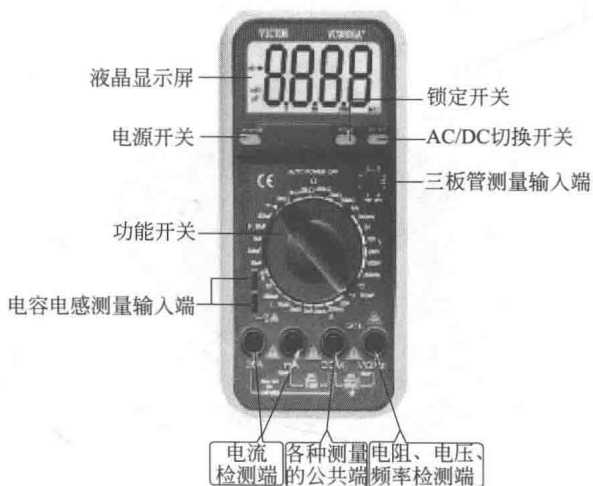
图 1-15 VC9805A + 型数字万用表面板
