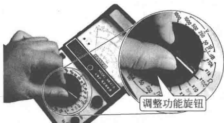
图 1-2 调整万用表的功能旋钮
