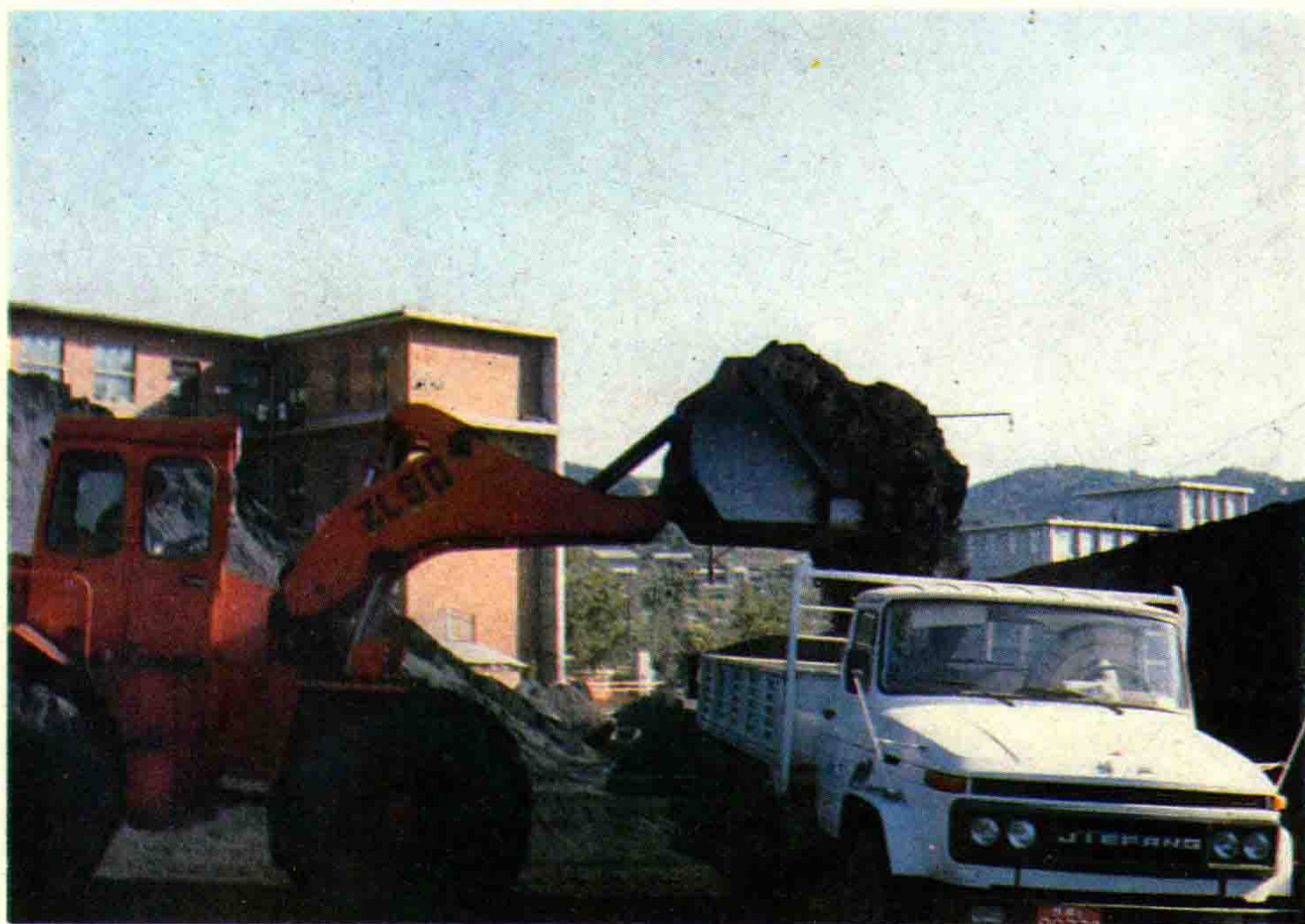
煤场倒运、装卸已实现了机械化作业
