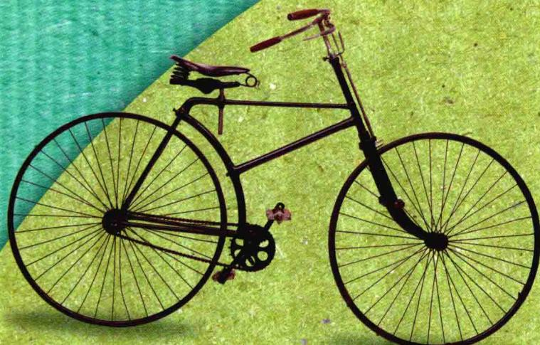
1886年，现代的“安全”自行车由托马斯·亨伯发明于英国。它很安全，因为两个轮子的大小相同，骑车人的脚可以够着地面，所以刹车更容易。踏板转动后轮，使脚与前轮保持距离。亨伯最大的灵感是在“松骨器”上加了一根链条，将踏板和后轮连接了起来。
