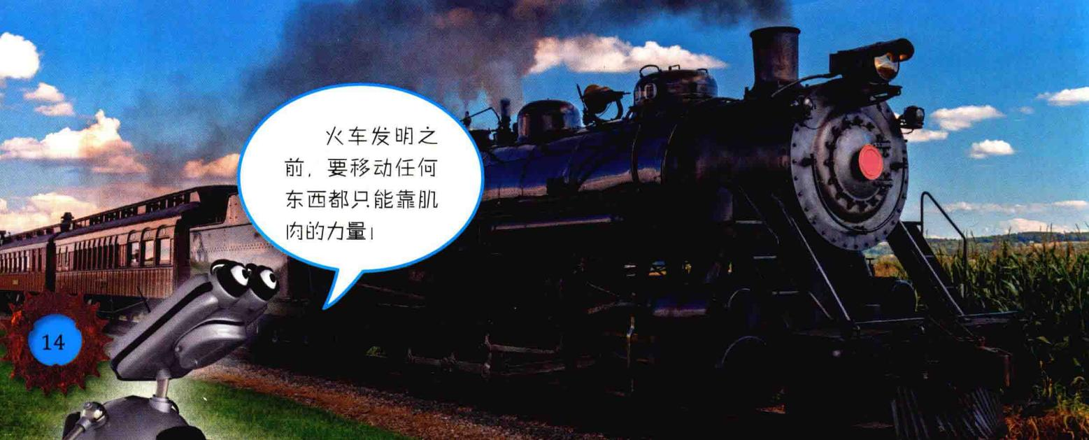
燃煤可以给水加热，以产生蒸汽。蒸汽的压力推动汽缸中的活塞。活塞上的杆子附连在曲柄上，可以转动车轮。
