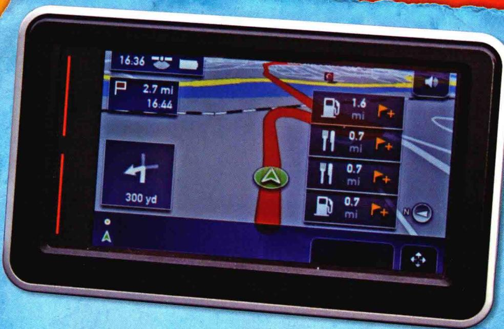
与**指南针**相比，用电脑控制的卫星导航使用起来更容易。太空卫星发射的信号会告知卫星导航设备自己的确切位置，随后，该设备的内置电脑会使用存储的地图制定出路线。第一个卫星导航系统于 1990 年在日本面世。
