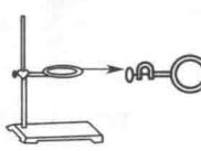
铁架台 铁圈                                                                                          | 铸铁                                             | 固定或放置反应容器；铁圈可代替漏斗架用于过滤                                                                                     | 安装时，拧紧固定铁圈的螺丝，以免放置反应容器后脱落                               |
