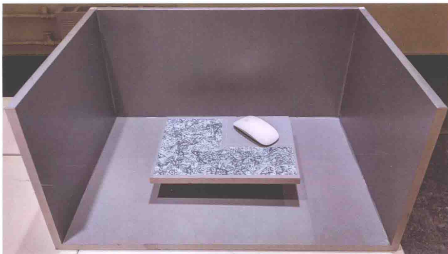
▲彩图1 笔者自己制作的配合 Vuforia 引擎的 3D 扫描仪
