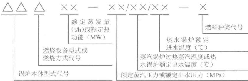
图 1.1 工业锅炉产品型号组成示意图
