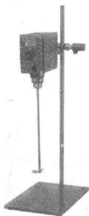
图 1-12 电动搅拌器示意图
