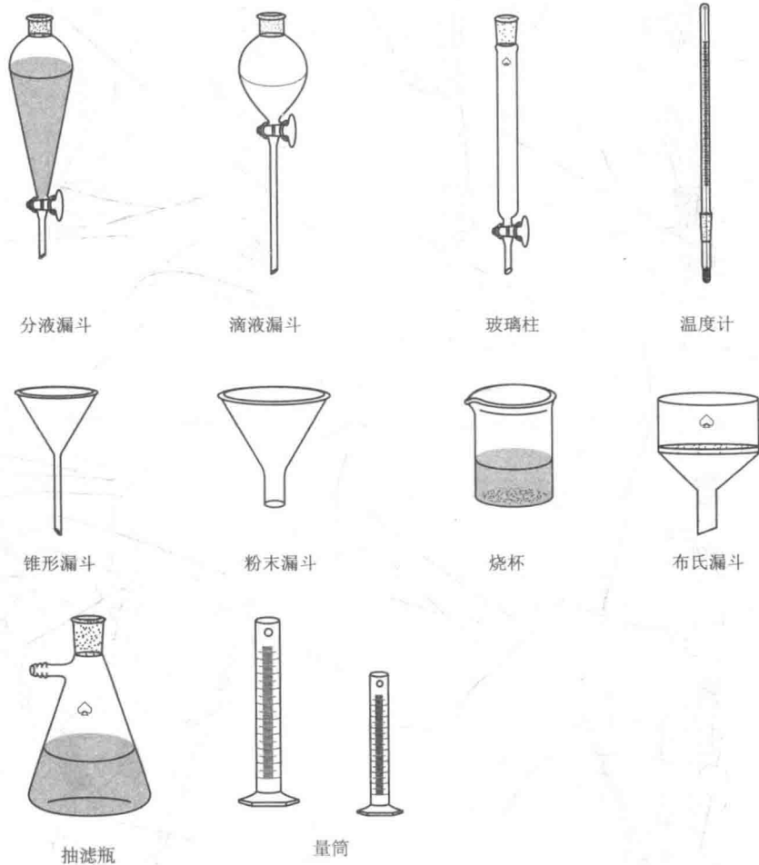
图 1-4 普通玻璃仪器示意图
