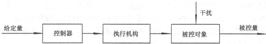
图 1-2 开环控制原理图
