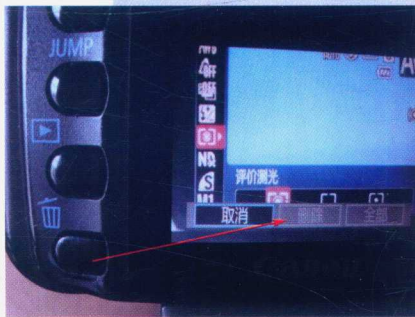
图 1-1-25 简便直观的功能键操作（画面为删除操作：若想删除图片只需按动删除键，显示屏上出现对话框后按确认图像即被删除）
