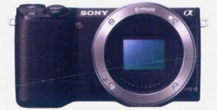
图 1-1-9b 从卡口向内可见，微单相机无反光镜
