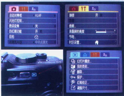
图 1-1-24 带方框的三角形按钮，为拍摄状态与播放状态切换键
