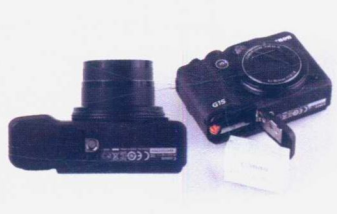
图 1-1-21b 普及类数码相机佳能 G15 底部
