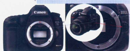
图 1-1-4 单反数码相机。单反数码相机采用升降反光板（从卡口向内看到）；可以更换镜头（红箭头所指为镜头释放按钮）。
