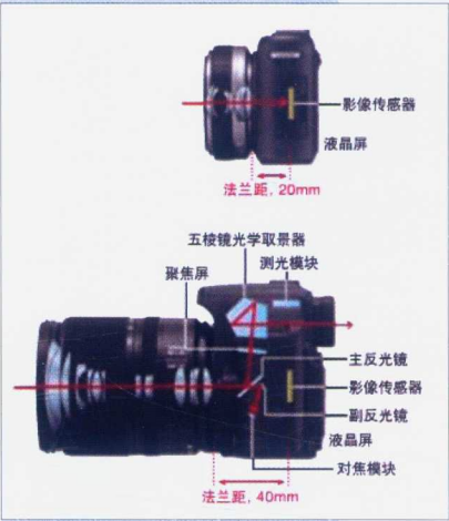
图 1-1-9a 微单（上）与单反（下）结构对比
