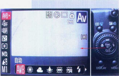
图 1-1-22 常见参数设置。按下功能键（SETUP），多组选择设置参数的菜单会出现在液晶屏上
