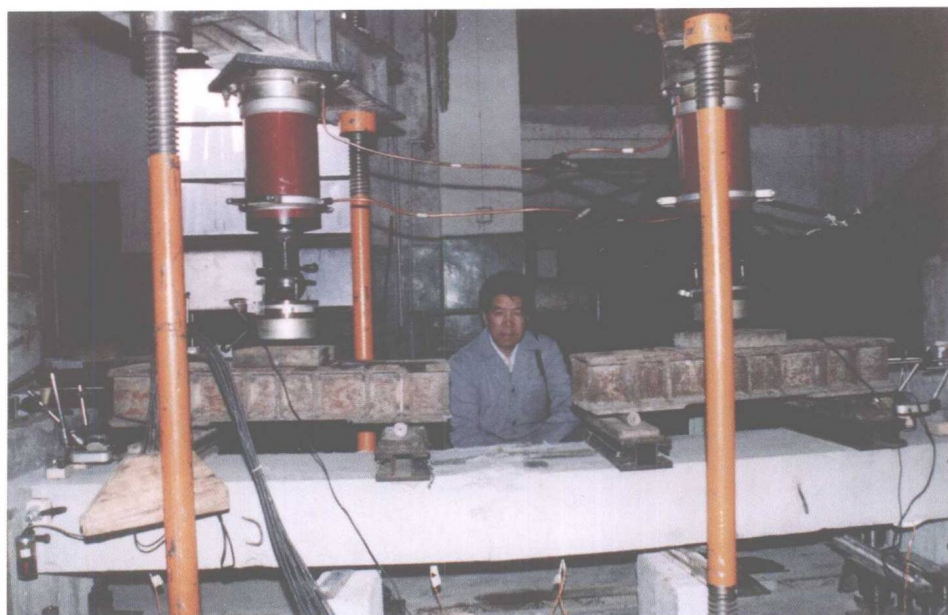
做高强混凝土板实验
