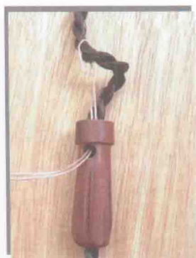
二、用细铜丝横向勾住绒扣，由顶孔穿出琴轸侧孔
