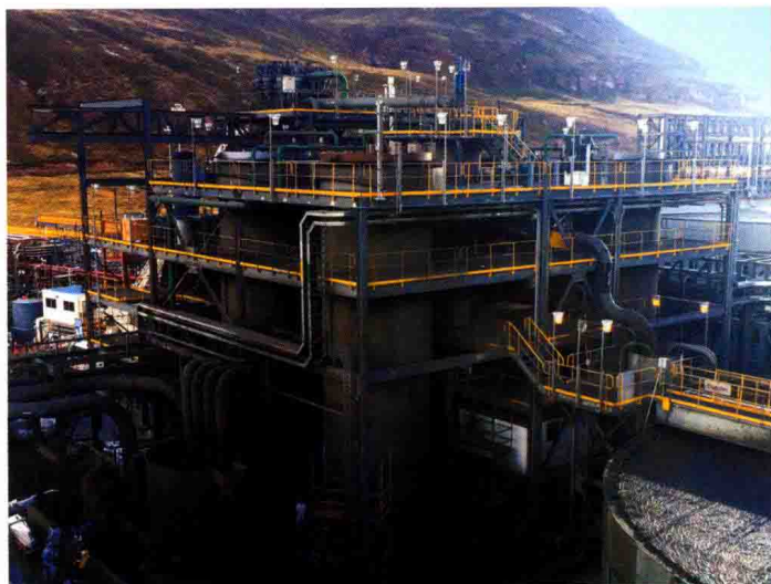
中铝秘鲁 TOROMOCHO 项目 KYZ-4314 浮选柱使用现场
