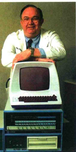
由美国计算机工 程师罗伯茨装配的 世界上第一台微型 计算机 Altair 8800
