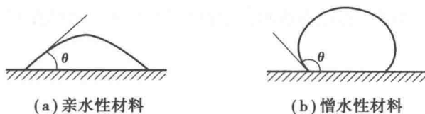
图 1.1 材料的润湿示意图
