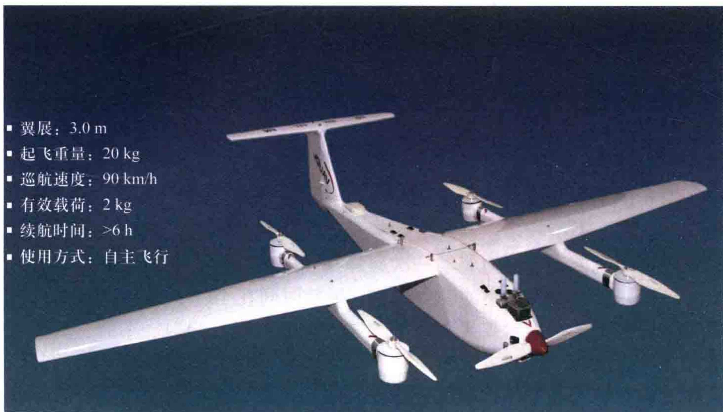
图 1-4 复合翼无人机 CW-20 大鹏
