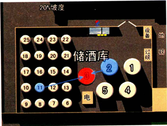
图3-4 罐体位置及编号示意图
